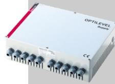
Point d'interface et de séparation entre les jauges et le système de niveau supérieur. Il comprend l'alimentation des sondes et leur isolation galvanique. Il transmet les informations de niveau par une interface série vers un terminal tactile ou vers d'autres systèmes de gestion.
