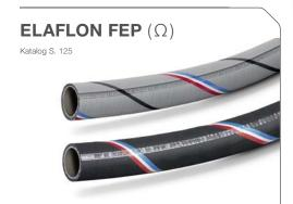
Universalschlauch mit nahtloser, transparenter Innenschicht aus Teflon® FEP. Geeignet für alle gebräuchlichen Medien bis +100°C, kurzzeitig bis +130°C. FDA- und USP Class VI-konform.
