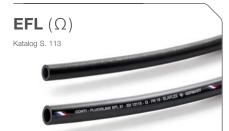
'FLUORLINE', hochflexibler Universal-Zapfschlauch mit nahtloser, transparenter Innenschicht aus THV-Fluorpolymer - geeignet für die meisten gebräuchlichen Medien. Nicht auslaugend und nicht verfärbend, daher ideal für hochreine und sensible Produkte. Diffusions- und geruchsdicht. Entspricht EN 1360 und EN 12115. Temperaturbereich -40°C bis +100°C.
