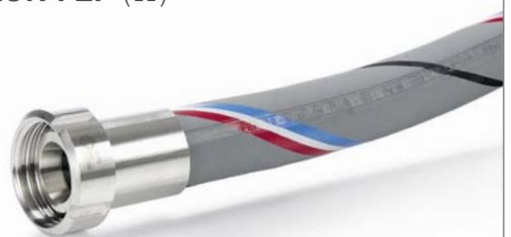
Universalschlauch mit nahtloser, transparenter Innenschicht aus Teflon® FEP. Geeignet für alle gebräuchlichen Medien bis +100 °C, kurzzeitig bis +130 °C (medienabhängig).
