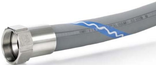
Universalschlauch POLYPAL 'CLEAN' mit leitfähiger, nahtloser UPE-Innenschicht und lichtgrauem Außengummi, für eine Vielzahl von Medien bis +100 °C. Entspricht EN 12115. FDA- und USP Class VI-konform. Ausdämpfbar für Reinigung und Sterilisation bei +130 °C über maximal 30 Minuten (offenes System).
