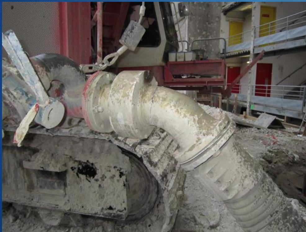
Les raccords tournants utilisés dans le BTP sont soumis à rude épreuve. Les usages et destinations sont très variés. C'est pour cette raison que dans notre gamme, les TP 2000 robuste sont destinés aux fluides à haute pression que les TP 7000 encore plus robustes supportent des pressions plus importantes et des effets de traction de flexible plus intenses.
