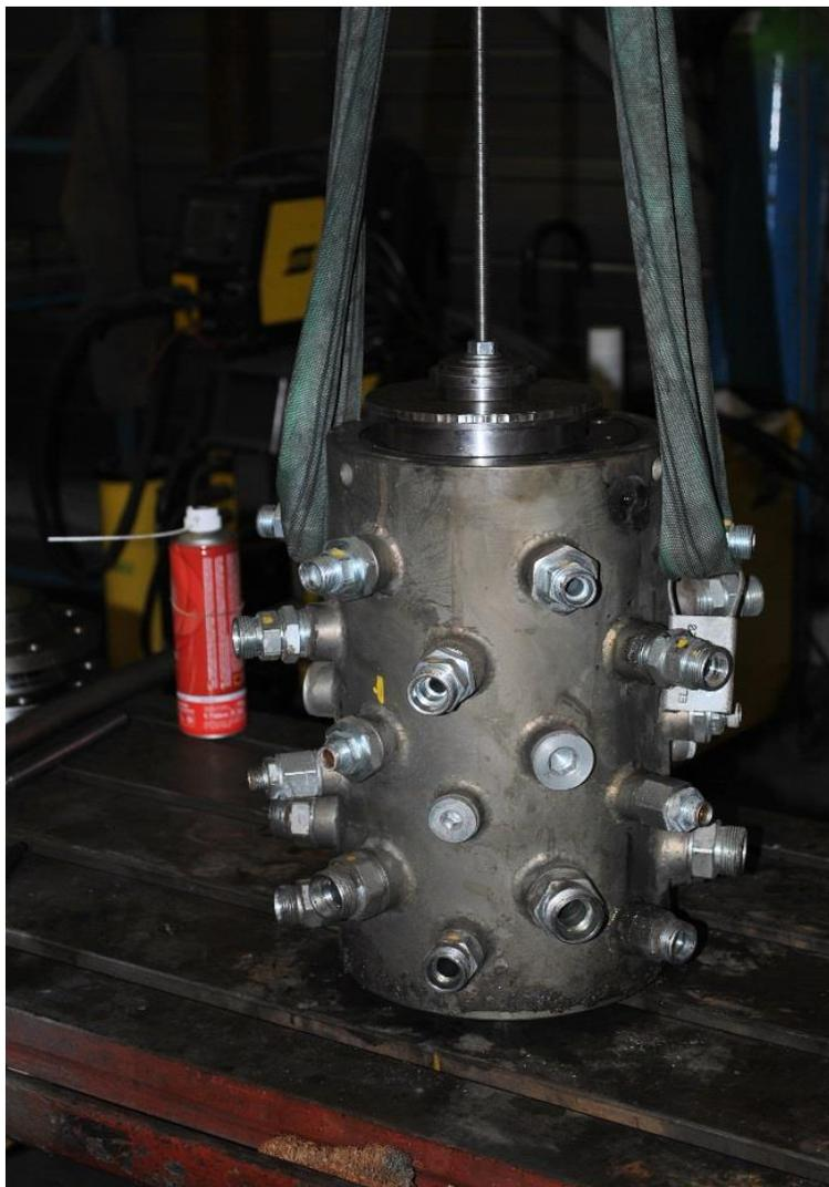
Le métier de fondeur est par nature consommateur de raccords multi-passages de type TP 8000. Ils sont installés sur des carrousels et résistent à des températures élevées, des fluides caloporteurs.
